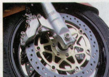
W przednich hamulcach Hondy pracują czterohoczkowe zaciski
