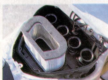
Po podniesieniu zbiornika paliwa R 1 uzyskujemy łatwy dostęp do filtra powietrza
