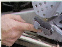
Podnóżki Kawasaki zostały zupełnie starte podczas jazdy w zakrętach
